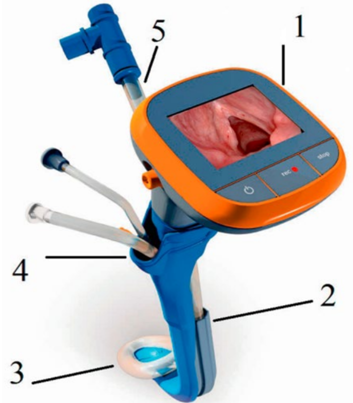
Obr. 1 TotalTrack VLM – video intubační laryngeální maska (poskytnuto firmou Mediflow) 1 – monitor se zobrazením vstupu do hrtanu, 2 – intubační kanál, 3 – manžeta laryngeální masky, 4 – kanály pro odsávání sekretu z vchodu do hrtanu a pro zavedení žaludeční sondy, 5 – tracheální rourka s okruhem
