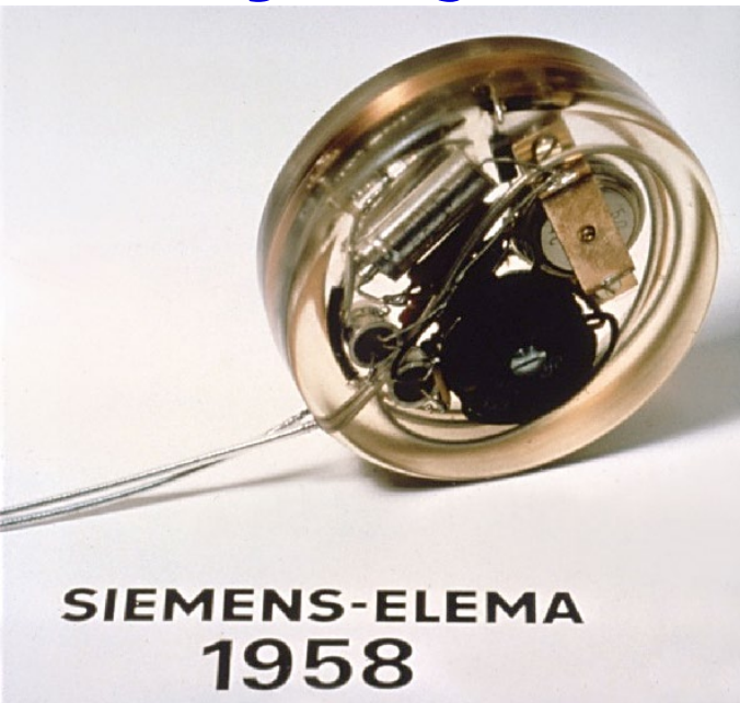
První implantabilní kardiostimulátor (55mm x 16 mm) 1958
