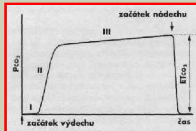
Obr. 4.1. Kapnografická křivka. I – anatomický mrtvý prostor; II – přechod z anatomického mrtvého prostoru do alveolárního plátů; III – alveolární plátů.
