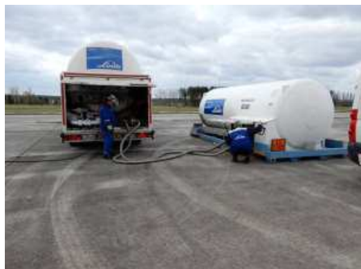
Obr. 10 Přečerpávání CO 2 z autocisterny
